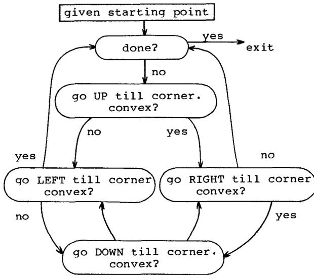
Figure 3: Flowchart for Edge Tracking
